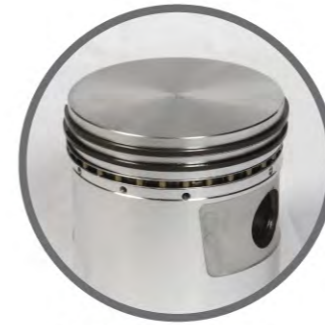
● 경원의 기술로 설계하고 제작한 피스톤 및 3피스 광폭 오일링 적용으로 오일 소모량 최소화
